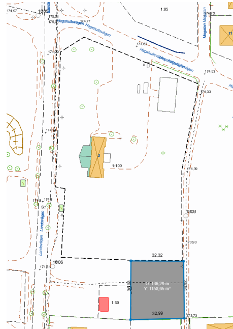
Figur 13. Det markerade området med blå ram utgör en lågpunkt med en yta om cirka 1 160 m 2 . Området är lämpligt att använda som fördröjningsyta för kraftiga regn och skyfall.
